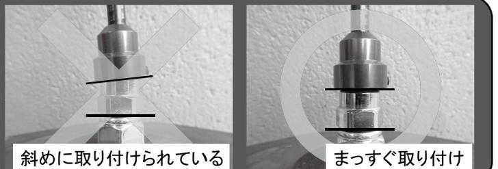
**確認** 延長ダイヤルの取り付け角度は無理に曲げないように注意してください。無理に曲げたり、急な角度で取り付けると内部ワイヤー部分に負担がかかり延長ダイヤルのまわりが悪くなります。
