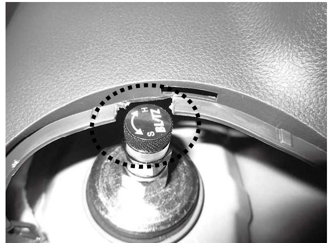
リア右側減衰調整ダイヤル取り付け状態(LA610S) 左右とも減衰調整ダイヤルと内装パネルが干渉する ため干渉部分を加工してください サービスホールカバーの取り付けは可能です
