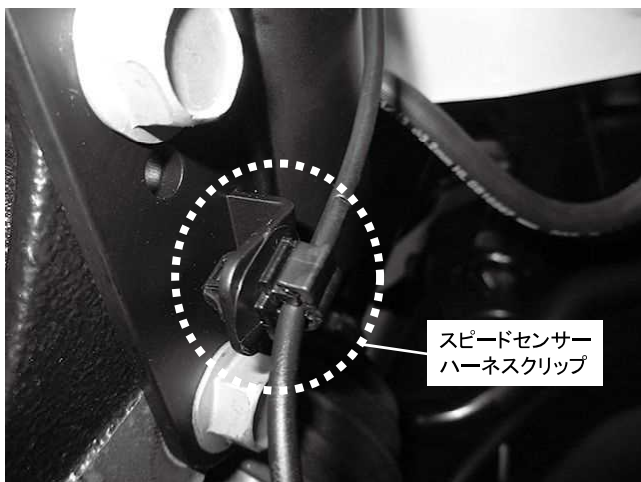
スピードセンサーハーネスクリップ取り付け ※クリップがブラケットに固定できない、またはハーネスが 突っ張ってしまう場合にはクリップをハーネスから取り外し、 クリップをロアブラケットに付けてからハーネスを取り付けてください
