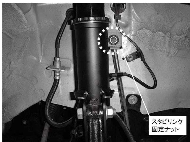
スタビリンク固定ナット 1カ所締め付け 締め付けトルク: 48\text{N}\cdot\text{m} ( 4.9\text{kgf}\cdot\text{m} )
