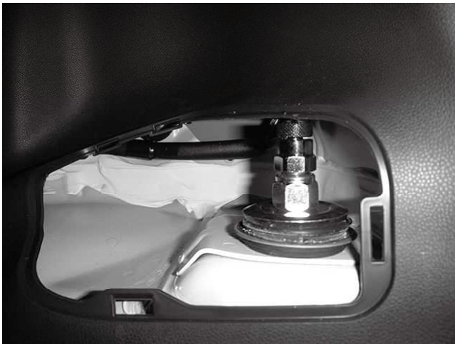
リア右側減衰調整ダイヤル取り付け状態(LA110S) ※写真はサービスホールカバーを 取り外した状態です
