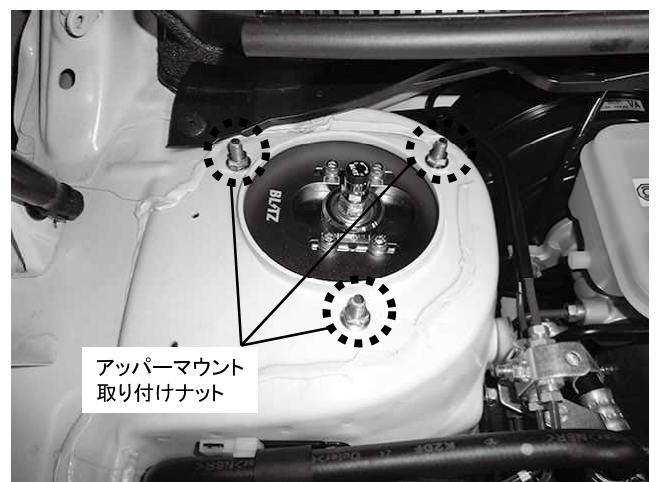
アッパーマウント取り付けナット 3カ所締め付け 締め付けトルク: 25N・m(2.5kgf・m) ※製品付属のM8ナットを使用してください
