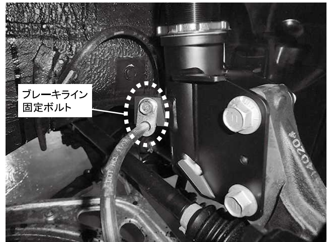
ブレーキライン固定ボルト 1カ所締め付け 締め付けトルク: 33N・m(3.4kgf・m) ※ネジ部に塗装がついて締め付けが渋い場合があります
