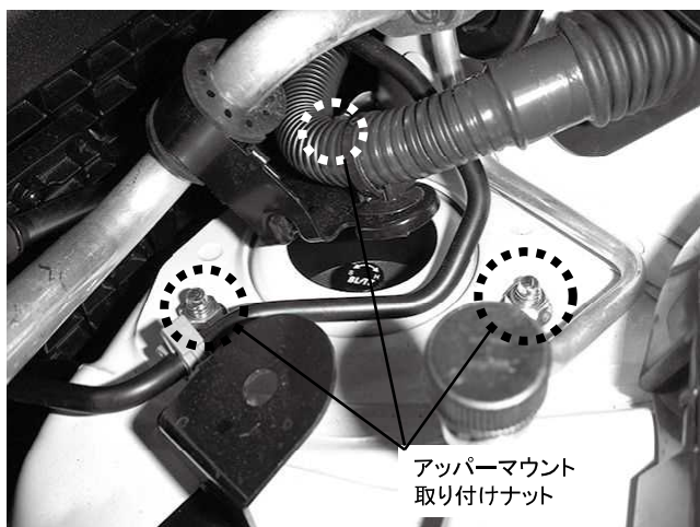
アッパーマウント 取り付けナット 3カ所締め付け 締め付けトルク: 38N・m(3.9kgf・m) ※製品付属のM8ナットを使用してください
