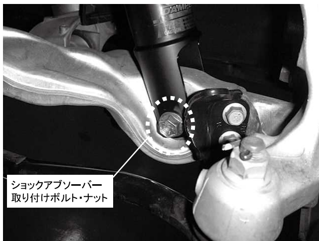
ショックアブソーバー下側取り付けボルト・ナット 1カ所締め付け 締め付けトルク: 113N・m(12.0kgf・m)
