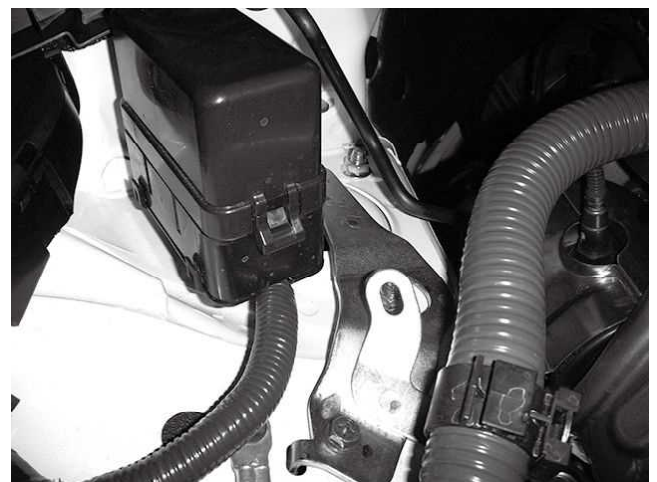
フロント右側(運転席側)取り付け状態 アッパーマウント上部にヒューズボックスがあるため、 ヒューズボックスを固定しているステーを一旦外し 作業してください
