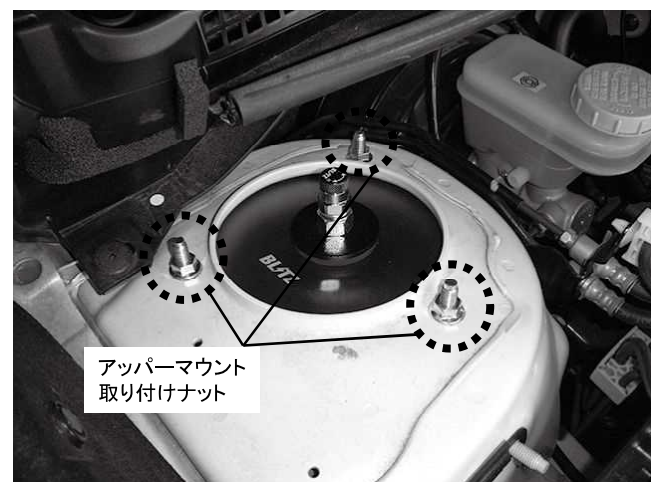
アッパーマウント取り付けナット 3カ所締め付け 締め付けトルク: 25N・m(2.5kgf・m) ※アッパーマウント取り付け時シャフトのセンターが オフセットしているため、上写真を参照しシャフトが 車両内側にくるよう取り付けてください
