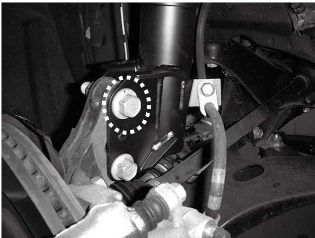
ナックルブラケット取り付けボルト上側は 純正でキャンバー調整機能付ボルトのため、 左右で位置を合わせて取り付けてください
