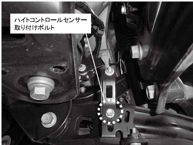
ハイドロコントロールセンサー取り付けボルト(左側のみ)
