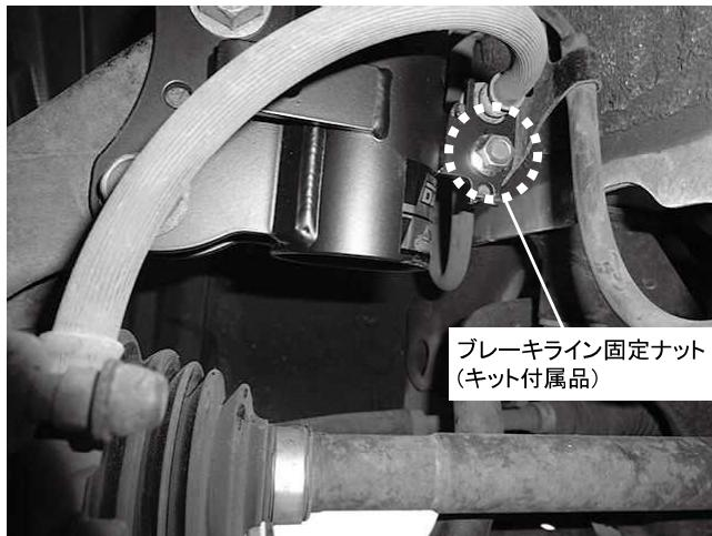
ブレーキライン固定ボルト・ナット 1カ所締め付け
