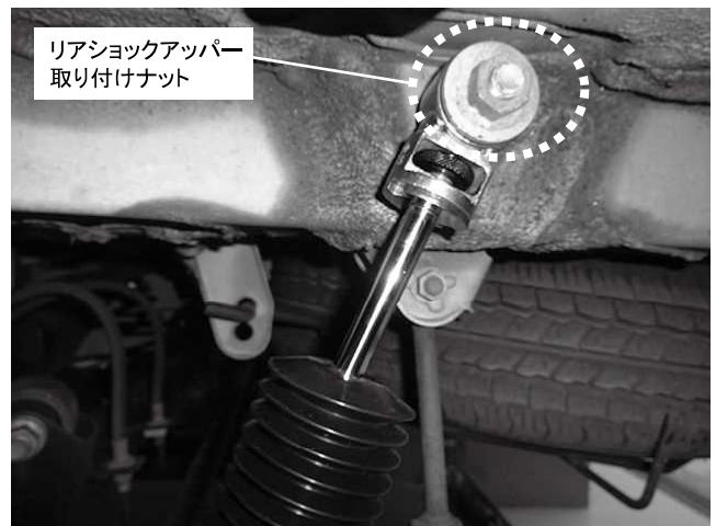
リアショックアッパー取り付けナット 1カ所締め付け
