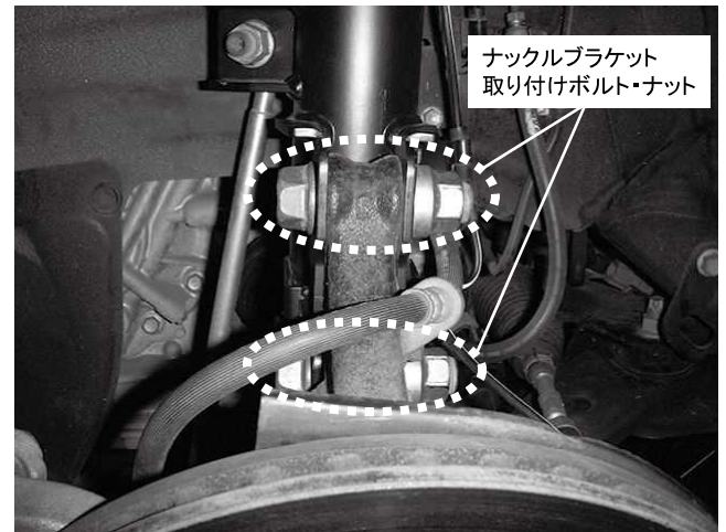
ナックルブラケット 取り付けボルト・ナット 2カ所締め付け 締め付けトルク: 240N・m(24.5kgf・m)
