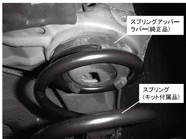
リアスプリングアッパー側取り付け状態 ※スプリング上部に純正スプリングアッパーラバー(インシュレーター)を取り付けてください
