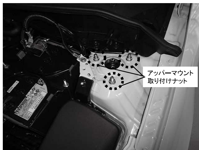
アッパーマウント取り付けナット 3カ所締め付け 締め付けトルク: 59N・m(6.0kgf・m) ※製品付属のM10ナットを使用してください
