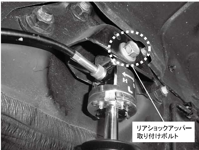
リアショックアッパー取り付けボルト 1カ所締め付け 締め付けトルク: 100N・m(10.2kgf・m)
