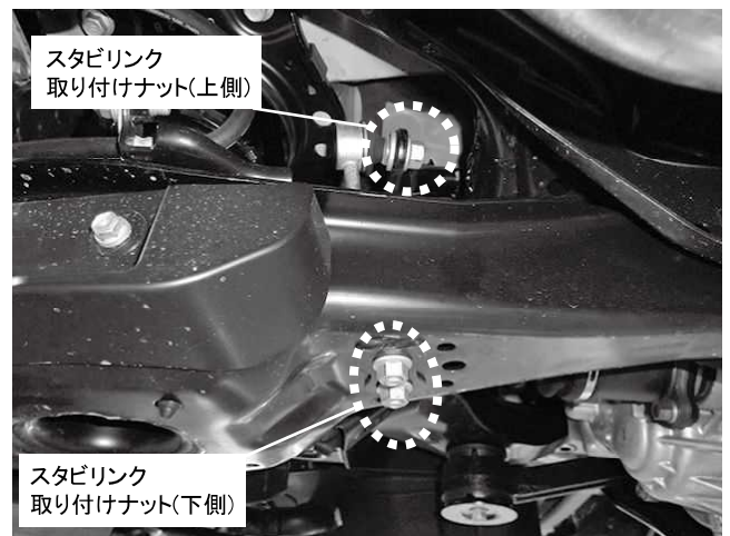
スタビリンク取り付けナット(上側) 1カ所締め付け 締め付けトルク: 98N・m(9.9kgf・m) スタビリンク取り付けナット(下側) 2カ所締め付け 締め付けトルク: 50N・m(5.1kgf・m)
