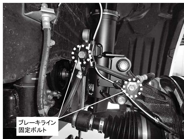
ブレーキライン固定ボルト 2カ所締め付け 締め付けトルク: 18.5N・m(1.9kgf・m) ※ネジ部に塗装がついて締め付けが渋い場合があります
