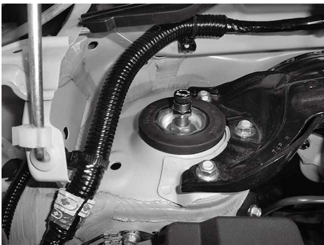
トップナット締め付け状態
