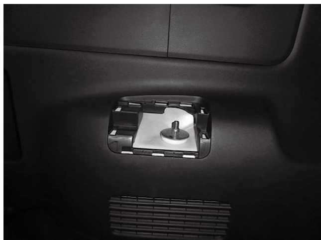
トップナット締め付け状態
