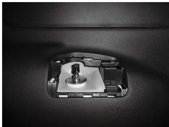
トップナット締め付け状態
