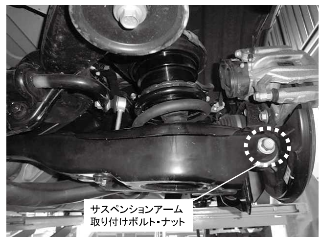
サスペンションアーム取り付けボルト・ナット 1カ所締め付け 締め付けトルク: 125N・m(12.7kgf・m)
