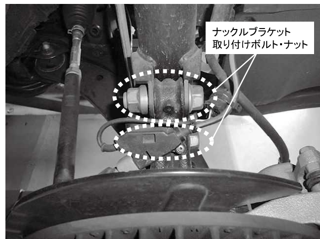
ナックルブラケット取り付けボルト・ナット 2カ所締め付け 締め付けトルク: 290N・m(29.7kgf・m)
