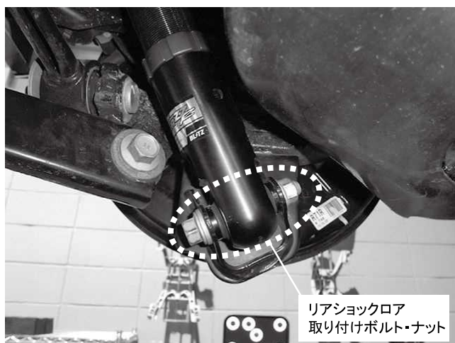
リアショックローア取り付けボルト・ナット 1カ所締め付け 締め付けトルク: 92N・m(9.4kgf・m)
