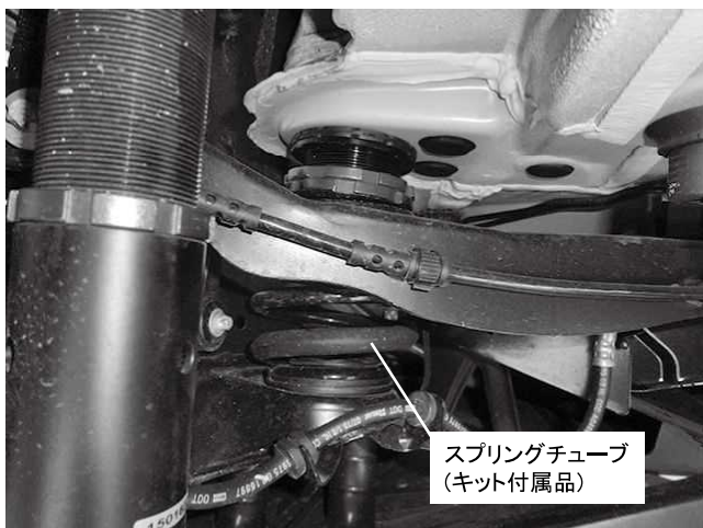
リアスプリング取り付け状態 ※スプリングが線間密着する際、必要に応じてスプリングチューブを使用してください
