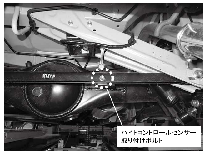
ハイトコントロールセンサー取り付けボルト 1カ所締め付け 締め付けトルク: 8.0N・m(0.8kgf・m)
