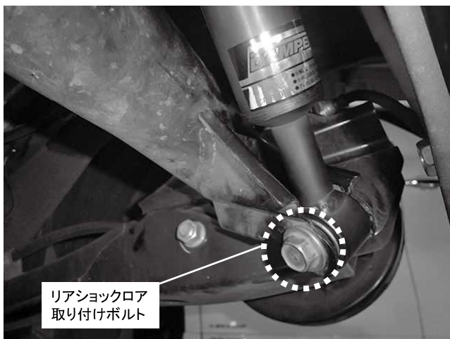
リアショックロア取り付けボルト 1カ所締め付け 締め付けトルク: 122N・m(12.4kgf・m)
