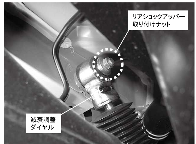
リアショックアッパー取り付けナット 1カ所締め付け 締め付けトルク: 31N・m(3.2kgf・m) ※減衰調整ダイヤルは構造上 リアショック上部についています
