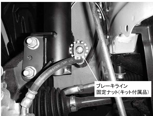
ブレーキライン取り付け状態 ブレーキラインの固定には純正のボルトとキット付属の ナットを使用して固定してください
