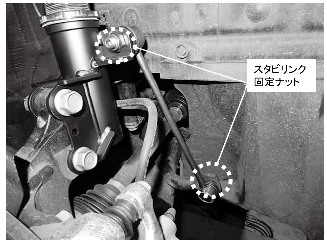
スタビリンク固定ナット 2カ所締め付け 締め付けトルク: 74N・m(7.5kgf・m) ※商品同梱スタビリンクを使用してください
