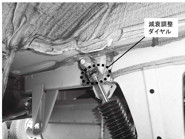
リアショックアブソーバー取り付け状態 ※減衰調整ダイヤルは構造上 リアショック上部についています
