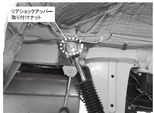
リアショックアッパー取り付けナット 1カ所締め付け 締め付けトルク: 85N・m(8.7kgf・m) ※純正ワッシャーも使用して取り付けください
