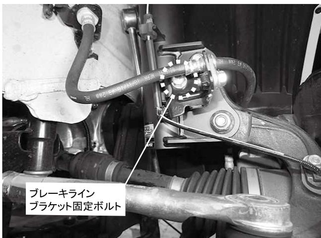
ブレーキラインブラケット固定ボルト 1カ所締め付け
