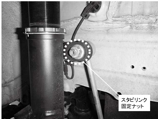
スタビリンク固定ナット 1ヵ所締め付け 締め付けトルク: 40\text{N}\cdot\text{m} ( 4.1\text{kgf}\cdot\text{m} )
