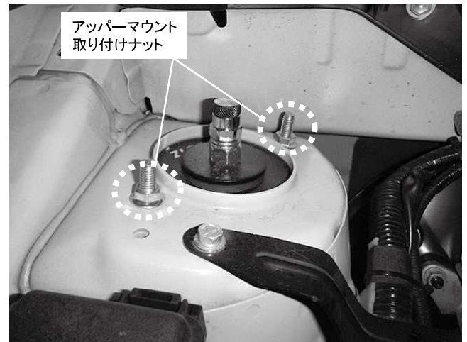
アッパーマウント取り付けナット 2ヵ所締め付け 締め付けトルク: 26.5\text{N}\cdot\text{m} ( 2.7\text{kgf}\cdot\text{m} ) ※製品付属のM8ナットを使用してください
