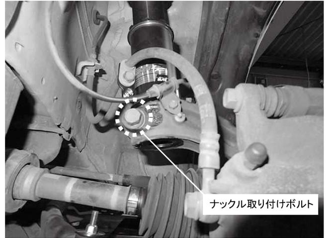
ナックル取り付けボルト 1カ所締め付け
