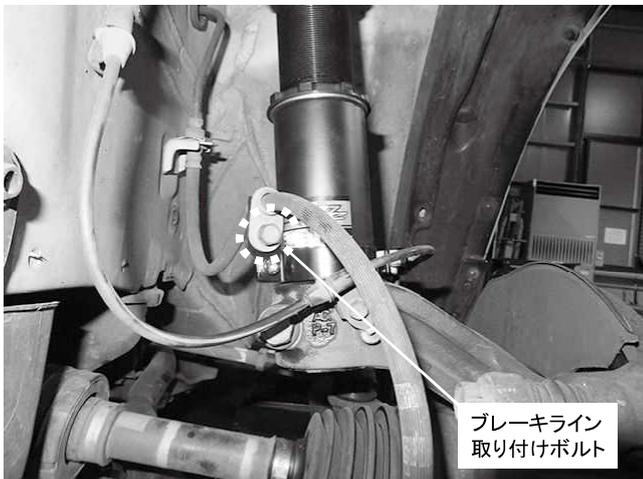
ブレーキライン取り付けボルト 1カ所締め付け
