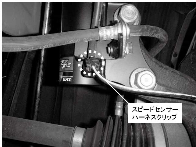
スピードセンサーのクリップ固定
