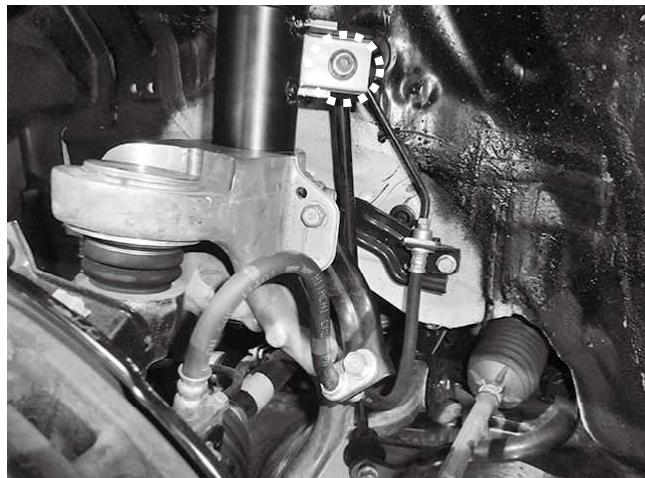
スタビリンク固定ナット 1カ所締め付け
