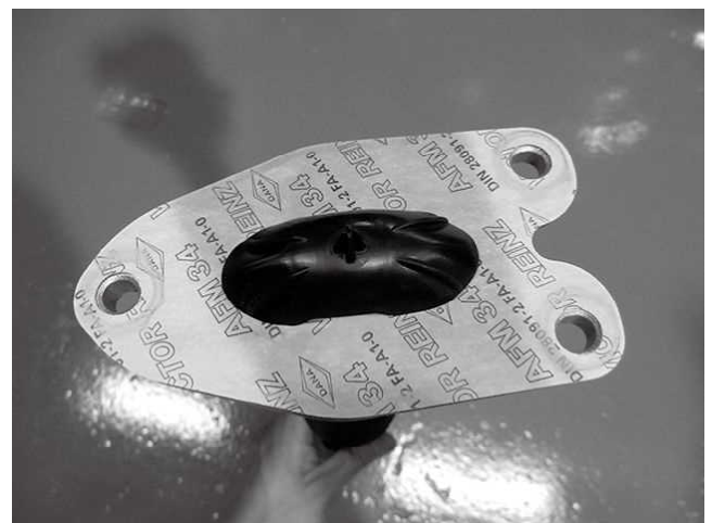
純正アッパーマウントについている 紙状ガスケットは再使用して取り付けてください
