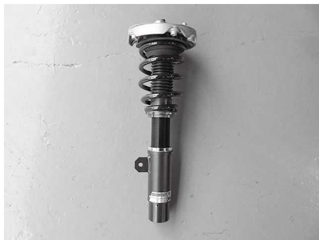
フロントアップアマウント組み付け状態
