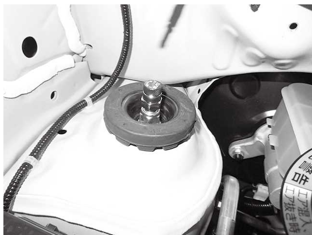
トップナット締め付け状態 ※写真はウィンドウウォッシャータンクを 取り外した状態です
