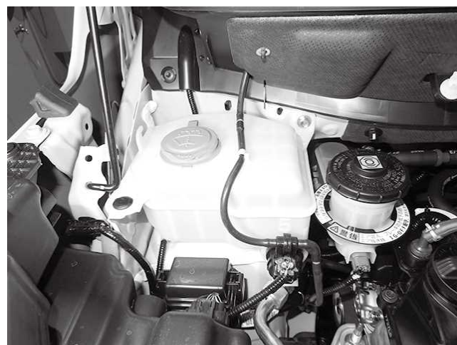
右(運転席)側アッパーマウント上部には ウィンドウウォッシャータンクがあるため作業のため 一旦取り外す必要があります タンクと減衰調整ダイヤルは干渉することなく取り付けできます
