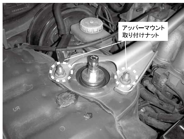
アッパーマウント取り付けナット 2ヵ所締め付け 締め付けトルク: 54\text{N}\cdot\text{m} ( 5.5\text{kgf}\cdot\text{m} ) ※製品付属のM10ナットを使用してください
