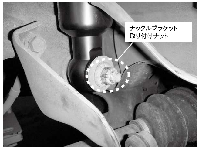
ナックルブラケット取り付けナット 1カ所締め付け 締め付けトルク: 107N・m(11kgf・m)
