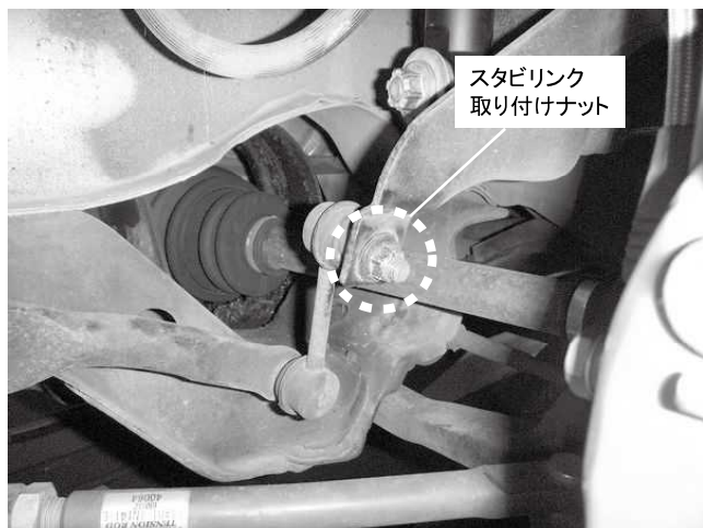
スタビリンク取り付けナット 1ヵ所締め付け 締め付けトルク: 47N・m(4.8kgf・m)
