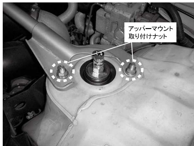
アッパーマウント取り付けナット 2ヵ所締め付け 締め付けトルク: 54N・m(5.5kgf・m) ※製品付属のM10ナットを使用してください
