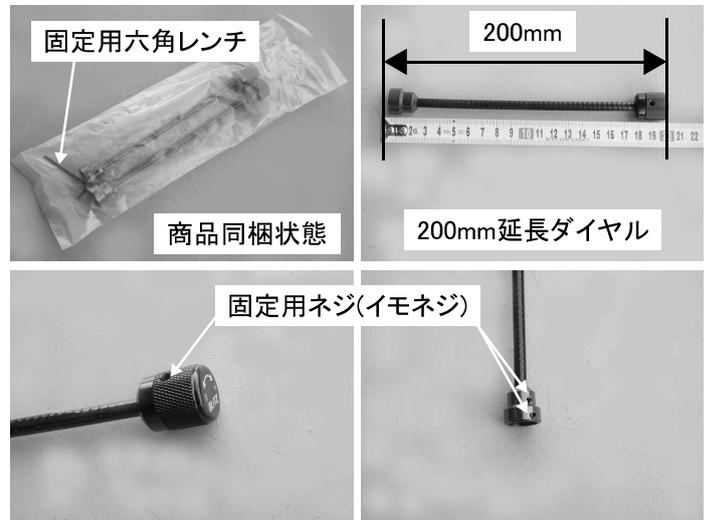
**確認** 減衰ダイヤルに延長ダイヤルを取り付ける時に、ダイヤルに対してまっすぐ取り付けください。斜めに取り付けられていると減衰ダイヤルと干渉して正常に回らなくなります。
