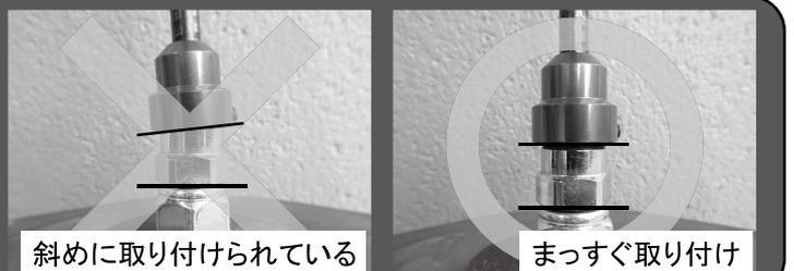
**確認** 延長ダイヤルの取り付け角度は無理に曲げないように注意してください。無理に曲げたり、急な角度で取り付けると内部ワイヤー部分に負担がかかり延長ダイヤルのまわりが悪くなります。
