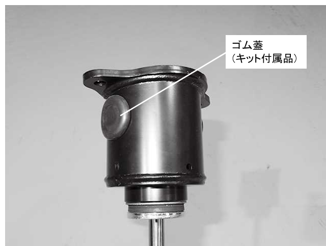
アッパーマウント内に砂利や水の侵入を防ぐためにゴム蓋を取り付けてください
