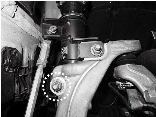
ダンパフォーク取り付けボルト・ナット(下部) 1カ所締め付け 締め付けトルク: 64\text{N}\cdot\text{m} ( 6.5\text{kgf}\cdot\text{m} )
