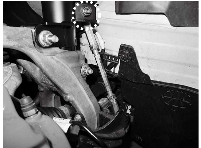
スタビリンク固定ナット 2カ所締め付け 締め付けトルク: 35\text{N}\cdot\text{m} ( 3.6\text{kgf}\cdot\text{m} ) ※調整式スタビリンクになっているので長さ・傾きを合わせて ナットを締め付け固定してください 締め付けトルク: 60\text{N}\cdot\text{m} ( 6.1\text{kgf}\cdot\text{m} )
