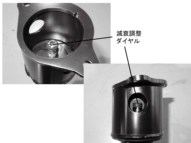
減衰力調整ダイヤルはアッパーマウント内部に配置されます 車両にショックを取り付け前の調整をお勧めします
