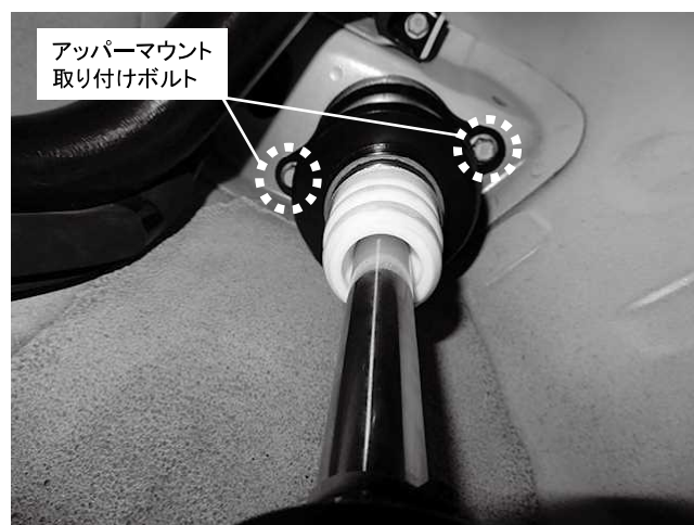
リアショックアッパーマウント取り付けボルト 2カ所締め付け
