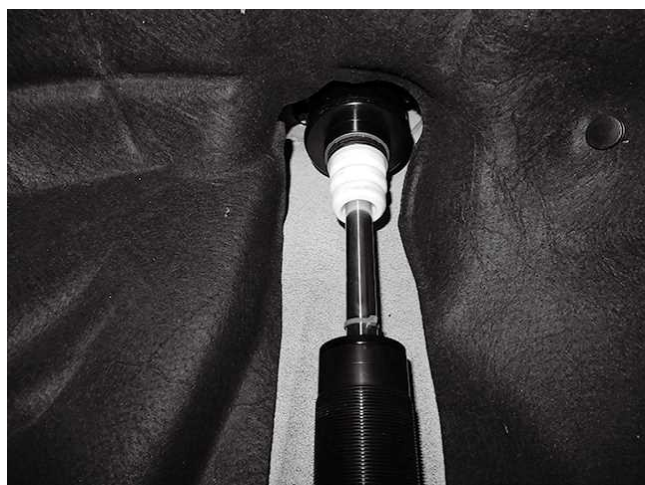
リアショック取り付け状態 ※写真はテスト時のためダストブーツを取り外しています
