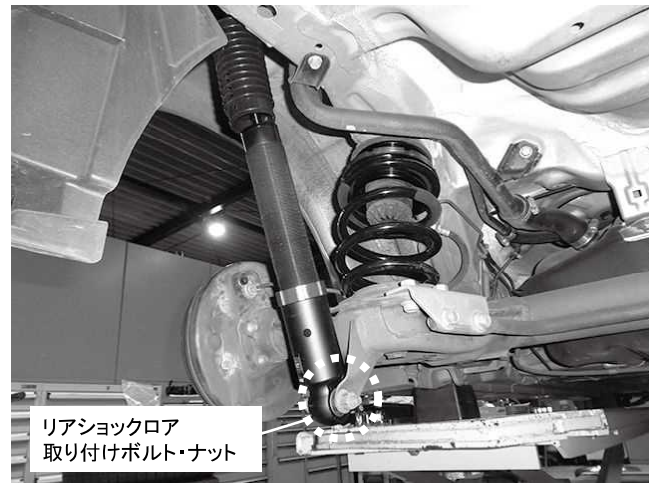
リアショックロア取り付けボルト・ナット 1カ所締め付け 締め付けトルク: 73N・m(7.44kgf・m)
