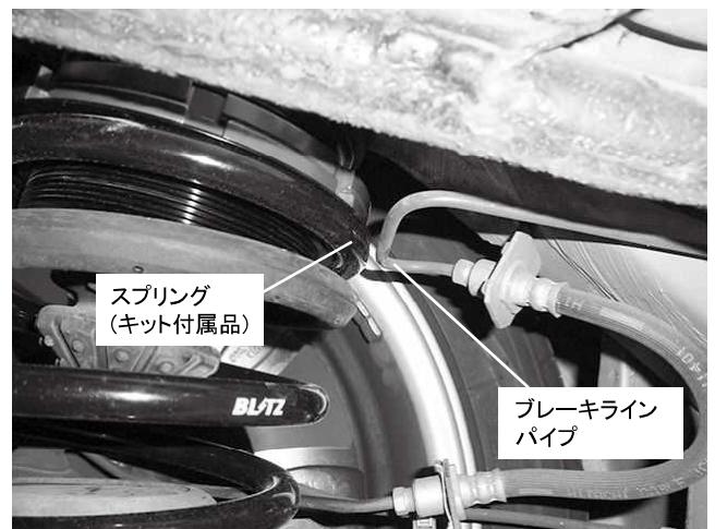
スプリングとブレーキラインパイプが非常に 近いため(特に助手席(左)側)取り付け後干渉が ないか確認してください
