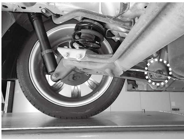
キット取り付け後、トーションビームの付け根の ボルトを緩め、1G(着地)状態で締め直してください 締め付けトルク: 65N・m(6.63kgf・m)
