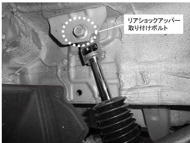
リアショックアッパ取り付けボルト 1カ所締め付け 締め付けトルク: 73N・m(7.44kgf・m)
