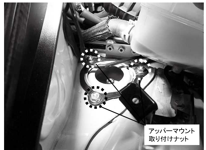
アッパーマウント取り付けナット 3カ所締め付け 締め付けトルク: 38\text{N}\cdot\text{m} ( 3.9\text{kgf}\cdot\text{m} ) ※製品付属のM8ナットを使用してください
