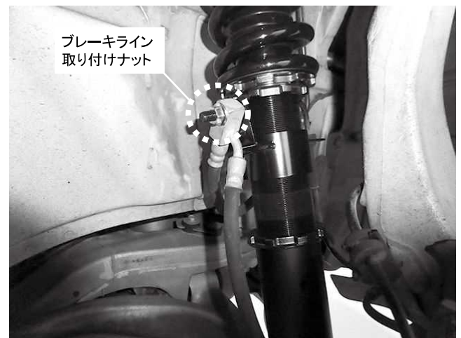
ブレーキライン取り付けナット 1カ所締め付け 締め付けトルク: 38\text{N}\cdot\text{m} ( 3.9\text{kgf}\cdot\text{m} ) ※ブレーキラインに干渉や突っ張りがないか確認してください
