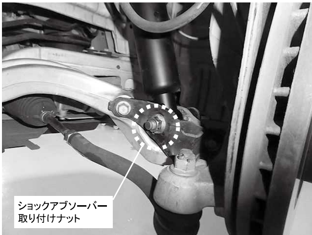
ショックアブソーバー下側取り付けナット 1カ所締め付け 締め付けトルク: 163\text{N}\cdot\text{m} ( 17.0\text{kgf}\cdot\text{m} )
