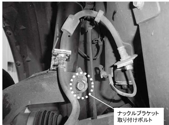
ナックルブラケット取り付けボルト締め付け
