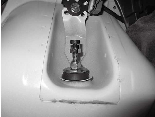
トップナット締め付け状態 ※写真はリア内装を取り外した状態です
