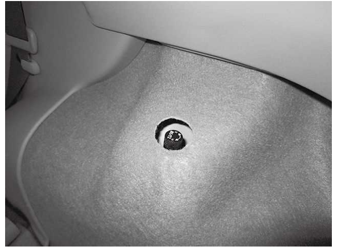
右(運転席)側内装パネル取り付け状態 ※加工せずリア内装は取り付け可能ですが 車両個体差により、内装と減衰ダイヤルが 干渉する場合があります
