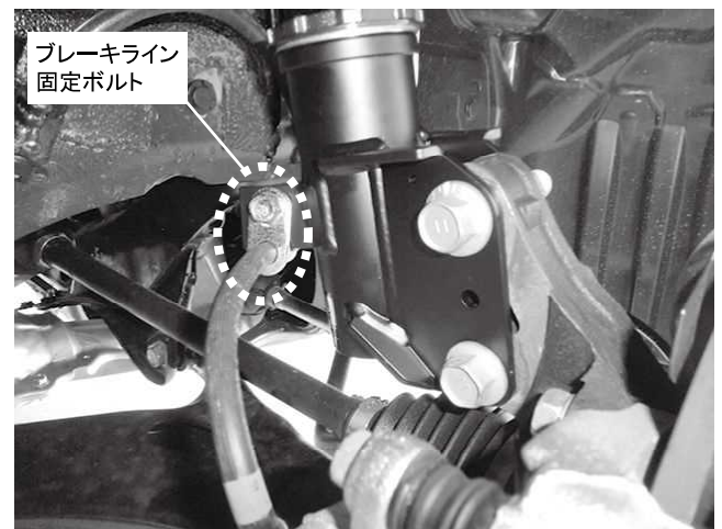
ブレーキライン 固定ボルト ブレーキライン固定ボルト 1カ所締め付け 締め付けトルク: 33N・m(3.4kgf・m) ※ネジ部に塗装がついて締め付けが渋い場合があります
