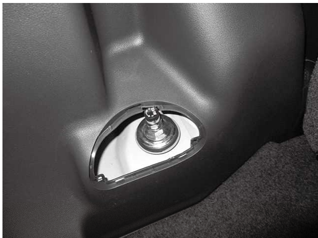
トップナット締め付け状態 ※写真はサービスホールカバーを 取り外した状態です
