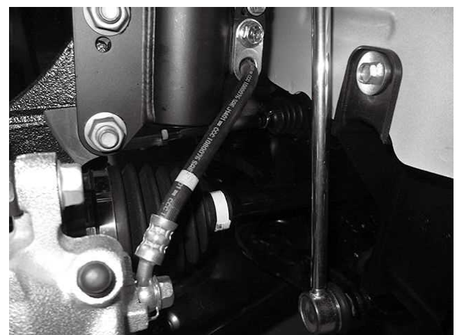
ブレーキライン取り付け状態 純正ショックに比べショック径など大きくなっているため ノーマルに比べて少し突っ張りますが異常ではありません
