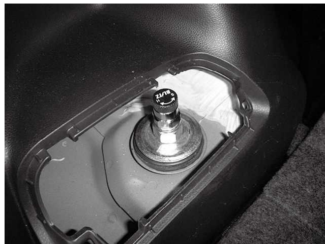
リア左側減衰調整ダイヤル取り付け状態 車両:L455S 車種によって減衰調整ダイヤルと内装パネルが干渉する ことがあります。その際は、干渉部分を加工するか、 サービスホールカバーを取り外して使用してください
