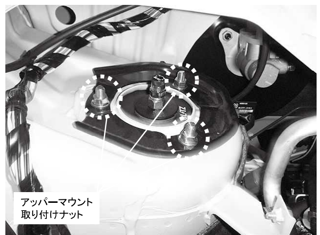
アッパーマウント 取り付けナット 3カ所締め付け 締め付けトルク: 45N・m(4.5kgf・m) ※製品付属のM10ナットを使用してください
