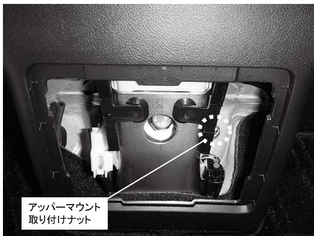
アッパーマウント取り付けナット 2カ所締め付け 締め付けトルク: 45\text{N}\cdot\text{m} ( 4.5\text{kgf}\cdot\text{m} ) ※製品付属のM10ナットを使用してください
