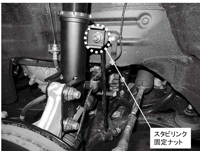
スタビリンク固定ナット 1カ所締め付け 締め付けトルク: 79N・m(8.1kgf・m)
