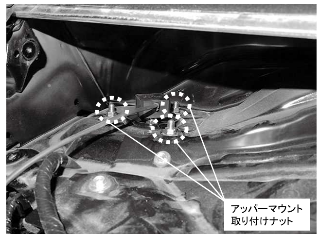
アップアマウント取り付けナット 3カ所締め付け 締め付けトルク: 64N・m(6.5kgf・m) ※上写真はダイヤルではなくモーター取り付け状態です ※製品付属のM10ナットを使用してください
