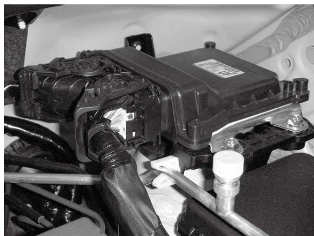
左側(助手席側)には上部にECUがあるため、 作業時はECUをずらして作業を行ってください ※この時ハーネスに負担がかからないようにしてください また、ずらした際にコネクタが抜けないように注意してください
