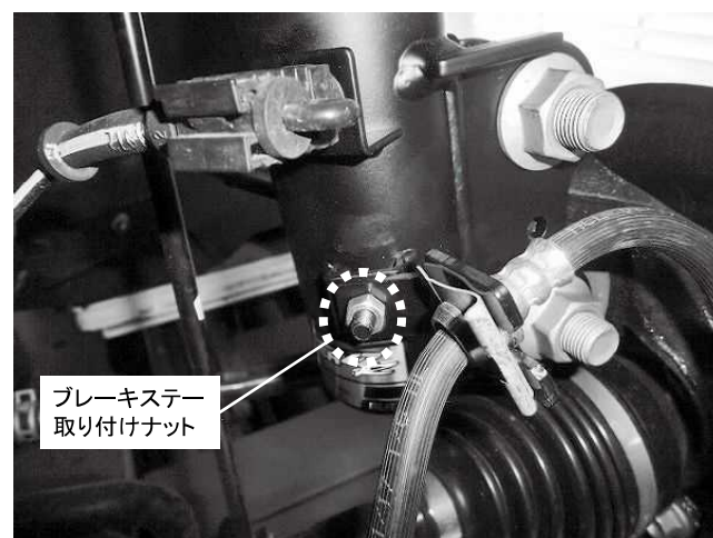
ブレーキステア取り付けナット 1カ所締め付け 締め付けトルク: 10N・m(1.0kgf・m)
