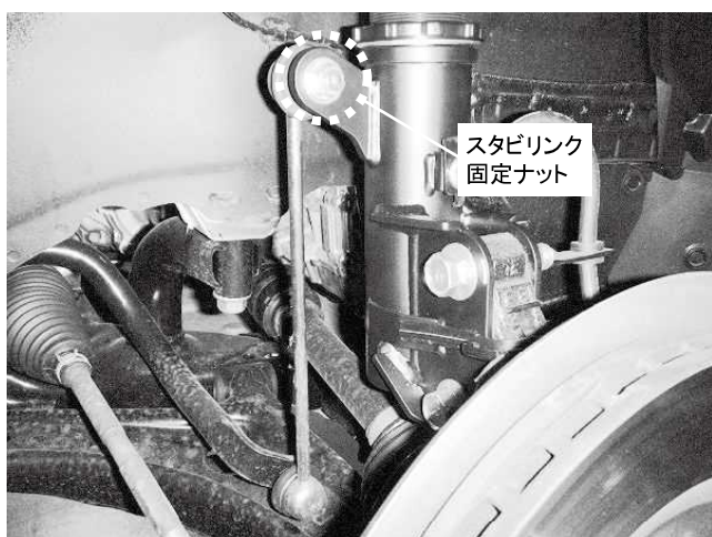
スタビリンク固定ナット 1カ所締め付け 締め付けトルク: 39N・m(3.9kgf・m)
