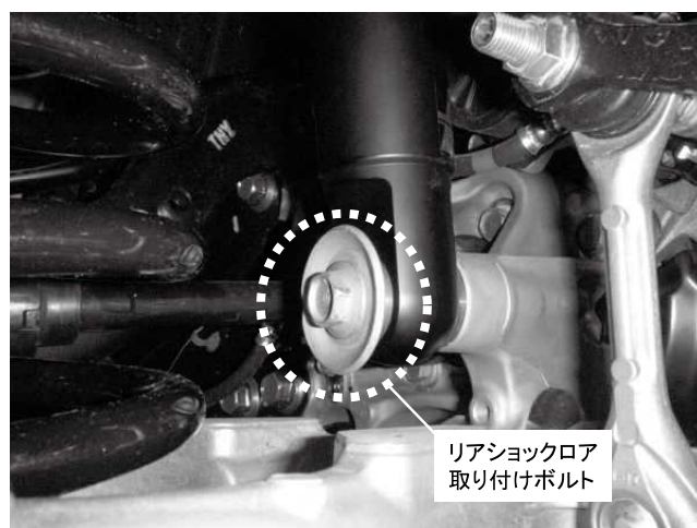
リアショックロー取り付けボルト 1カ所締め付け 締め付けトルク: 78N・m(8.0kgf・m) ※ワッシャーも取り付けください
