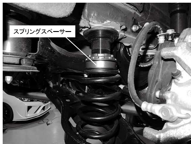
スプリングスペーサー取り付け状態
