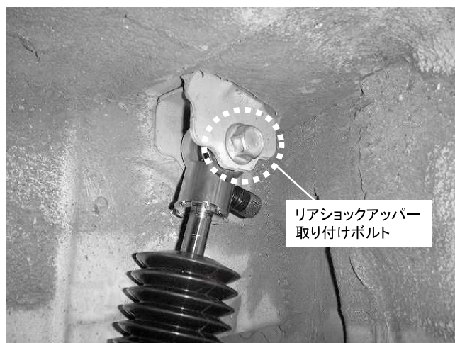
リアショックアッパー取り付けボルト 1カ所締め付け 締め付けトルク: 66N・m (6.7kgf・m) ※減衰調整ダイヤルの形状は製品と異なります
