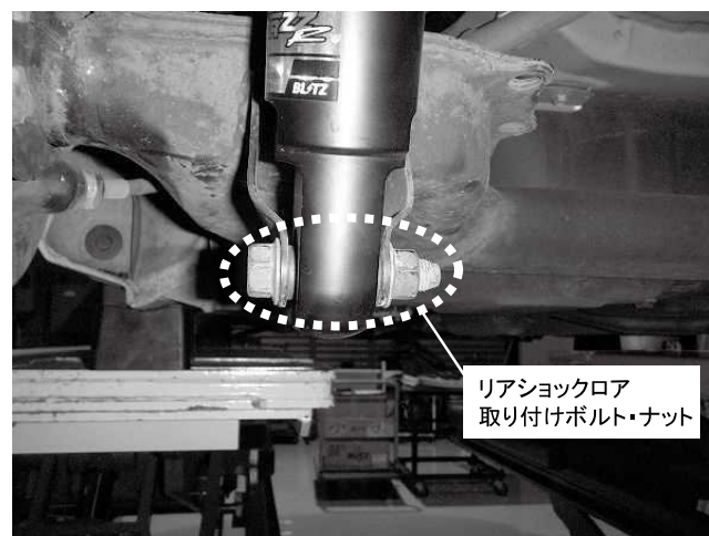
リアショックロー取り付けボルト・ナット 1カ所締め付け 締め付けトルク: 86N・m (8.8kgf・m)
