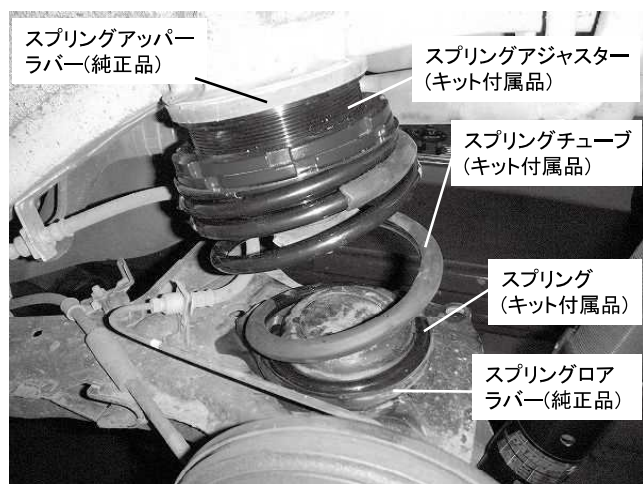
リアスプリング取り付け状態 ※上写真を参照し、キット付属のスプリングチューブを取り付けてください
