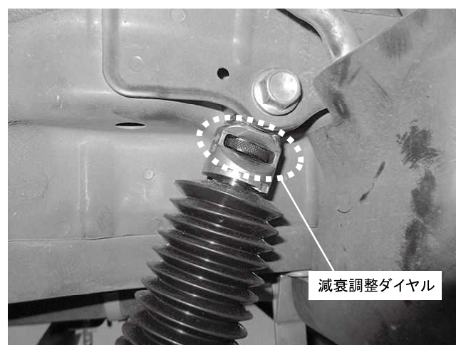
減衰調整ダイヤルはタイヤハウス内 ショックアブソーバー上部に配置されます
