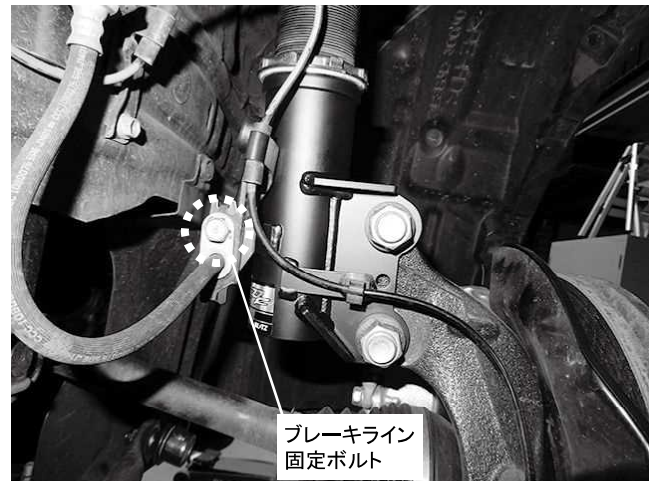
ブレーキライン固定ボルト 1カ所締め付け 締め付けトルク: 29N・m(2.9kgf・m) ※ネジ部に塗装がついて締め付けが渋い場合があります
