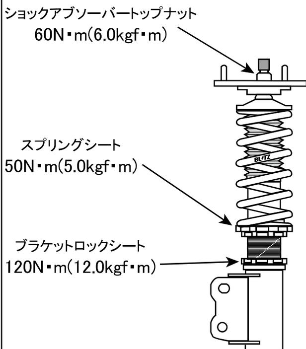
■ウィッシュボーンタイプ及びセパレートタイプ締め付けトルク
