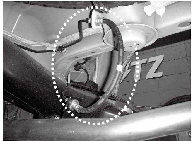
※リアスプリングを脱着する際、ブレーキホースが伸びきってしまうので、破損しないよう注意してください
