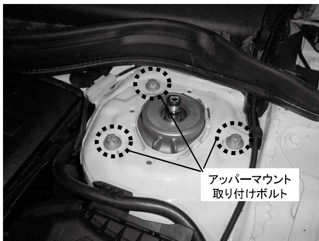
アッパーマウント取り付けボルト 3カ所締め付け ※アッパーマウント取り付け時、 E14のトルクスを使用します
