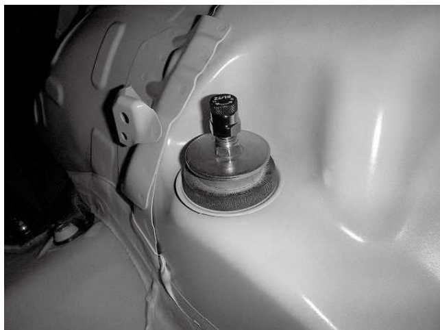
トップナット締め付け状態 ※写真は内装パネルを取り外した状態です
