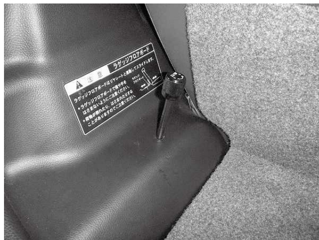
減衰延長ダイヤル取り付け状態(助手席側) ※内装パネルに穴あけ加工をして 取り付けています
