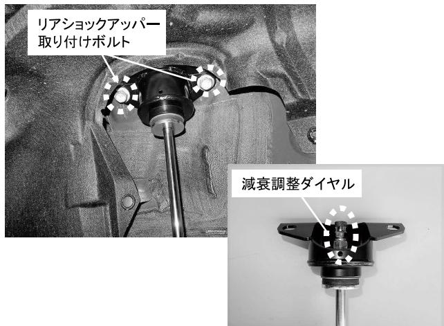
リアショックアッパー取り付けボルト 2カ所締め付け
