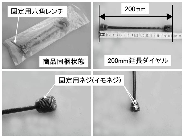
**確認** 減衰ダイヤルに延長ダイヤルを取り付ける時に、ダイヤルに対してまっすぐ取り付けてください。斜めに取り付けられていると減衰ダイヤルと干渉して正常に回らなくなります。
